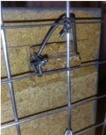
Іл. 4. Фіксування панелі за допомогою універсального кріпильного модуля, притягнутого дротом до сітки з протилежних точок монтажу. Вигляд ззаду стенда.
